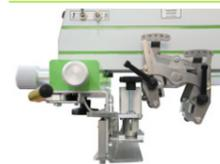
Toutes les têtes d'impression sont équipées d'un réglage de la hauteur, de l'angle et du parcours des râcles ainsi que de la vitesse d'impression et de recouvrement. Le mouvement de celles-ci est électrique par variateur AC à l'exception de la NANO qui est pneumatique.
