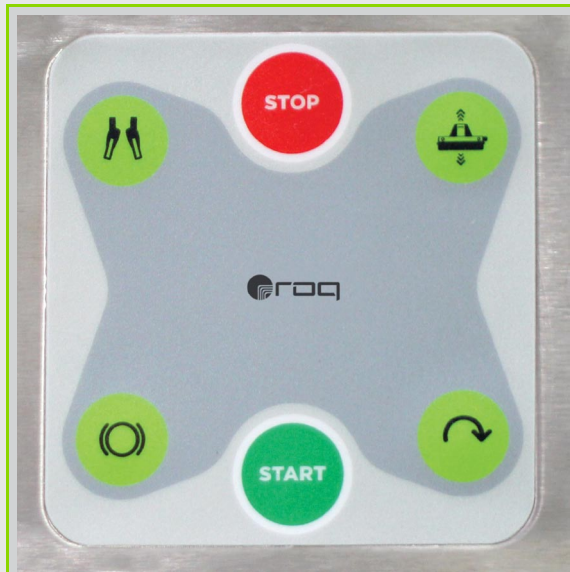
:: PUPITRE DE COMMANDE DANS CHAQUE TÊTE D'IMPRESSION
