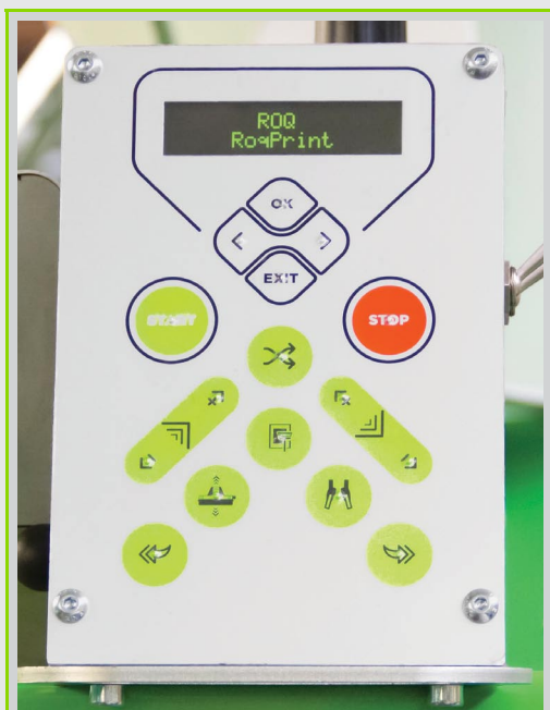
:: PANNEAU DE COMMANDE PIEZO: MOUVEMENT ET POSITIONNEMENT DU CADRE; ENREGISTREMENT ET MÉMORISATION DE LA POSITION DU CADRE
